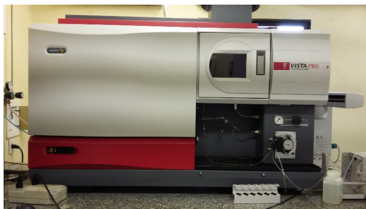
Figura 3 - Espectrômetro de emissão ótica com plasma indutivamente acoplado (ICP-OES) varian, modelo Vista Pro.
